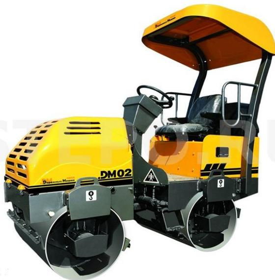
двухвальцовый вибрационный. Производство ООО «Завод Дорожных Машин», г.Рыбинск. Предназначен для уплотнения асфальтобетонных смесей при малых объемах работ по устройству покрытий и оснований парковых площадок, пешеходных и велосипедных дорожек, тротуаров, игровых и спортивных площадок, а также при их ремонте. Масса – 1,75 тонн, диаметр вальца – 560мм, ширина уплотняемой полосы – 900мм, двигатель
