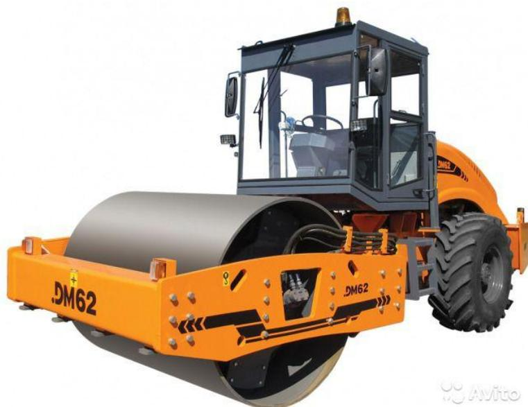
Каток грунтовый ДМ-62 самоходный одновальцовый вибрационный. Производство ООО «Завод Дорожных Машин», г.Рыбинск. Предназначен для уплотнения грунтов различной степени связности, щебня и гравия при больших и средних объемах работ по устройству оснований на автомобильных, городских дорогах любого типа и категорий, аэродромах, дамбах и промышленных площадках. Преимущества: Сбалансированные передняя
