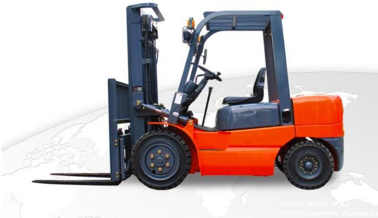
Грузоподъемность, кг 2000 Высота подъема груза 1930 Минимальный радиус разворота, мм 2170
