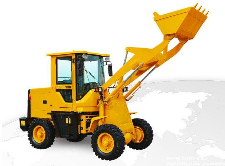
Грузоподъемность, кг 800 Объем ковша, м<sup>3</sup> 0,55 Минимальный радиус разворота, мм 4400
