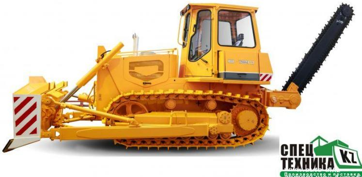
Производство ЗАО «Дормаш» г. Орел. Масса 17,5 тонн. Тяговый класс – 12 . Мощный и надежный двигатель ЯМЗ-236М2 132(180) л.с. Улучшенный аналог Шантуя SD-16 и ЧТЗ Б-10(Т-170) . Джойстики. Трансмиссия - Гидростатическая. Ширина гусеничной ленты 500/510/750 мм. Поставки напрямую с завода. Звоните прямо сейчас и задавайте интересующие Вас вопросы. Для подбора дополнительной комплектации свяжитесь с нашими специалистами
