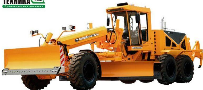
Производство ЗАО «Орелдормаш» г. Орел. Масса 24-25 тонн. Мощный двигатель - 220(300) л.с. (Deutz), дизель. Бульдозерный отвал, грейдерный отвал, рыхлитель, кондиционер. Рама шарнирно-сочлененная. Конкурент Катерпиллеру и Коматсу. Поставки напрямую с завода. Звоните прямо сейчас и задавайте интересующие Вас вопросы. Для подбора дополнительной комплектации свяжитесь с нашими специалистами
