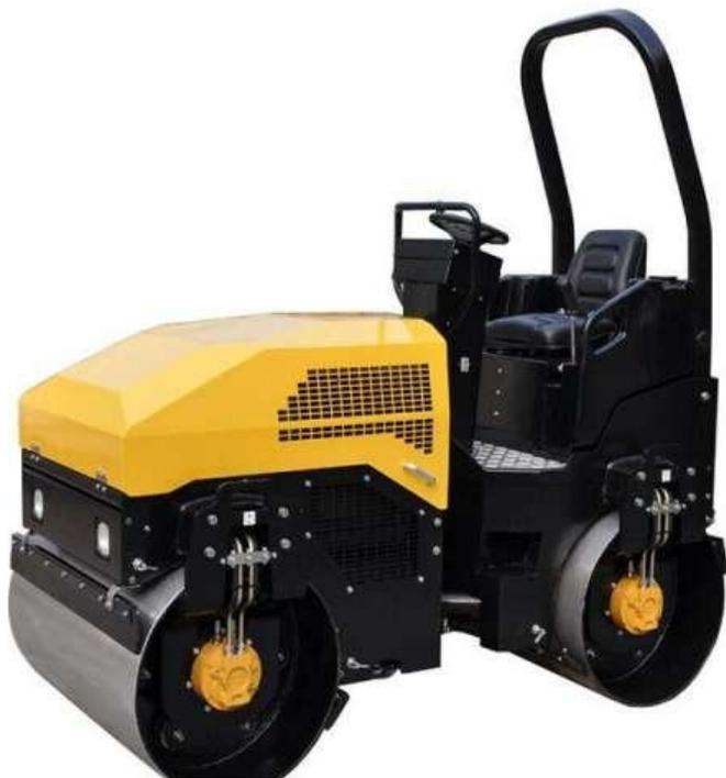
двухвальный вибрационный. Производство «Завод Дорожных Машин», г.Рыбинск.
