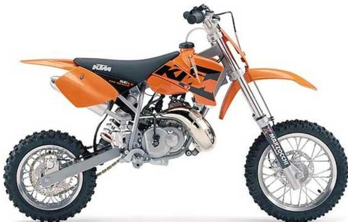
Рама Тип рамы: Рама из хромомолибденовых стальных профилированных труб Подвеска Тип передней подвески: 35 мм перевернутая телескопическая вилка Ход передней подвески, мм: 205 Тип задней подвески: Маятниковая с моноамортизатором, настраиваемая Ход задней подвески, мм: 185
