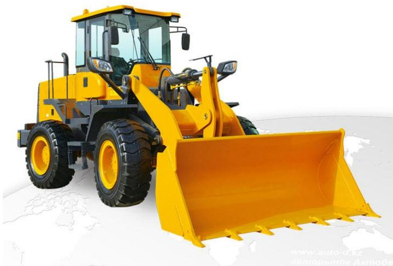
Грузоподъемность, кг 3200 Объем ковша, м<sup>3</sup> 1,8 Минимальный радиус разворота, мм 6000
