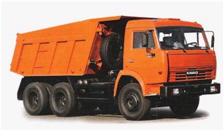
Самосвал Камаз 65115-026, грузоподъемность 15 тонн, объем 11 куб. м., двигатель 260 л.с., задняя разгрузка, МКБ, МОБ, боковая защита, задний брус безопасности, евро 3
